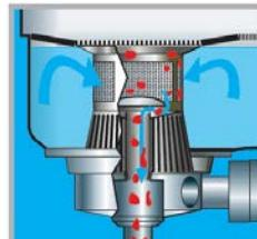
L'eau du réservoir de lavage est filtrée à plusieurs reprises tout au long du cycle, éliminant ainsi les toxines et contaminants du réservoir à des intervalles précis, pendant que le filtre se rince automatiquement (backflush).
