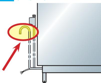
Cette fonctionnalité pratique permet de raccorder la machine à un drain de plancher ou mural jusqu'à 24 pouces de hauteur, puisqu'elle ne dépend pas de la gravité !
